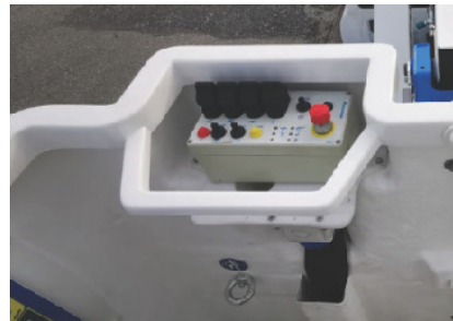
ระบบควบคุมฉุกเฉินของกระเช้าไฟฟ้า
