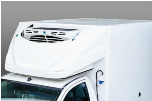
ระบบทำความเย็น ภายนอกห้องตู้เย็น
