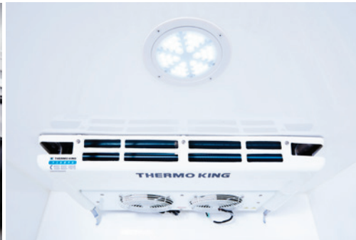
ระบบทำความเย็น ภายในห้องตู้เย็น
